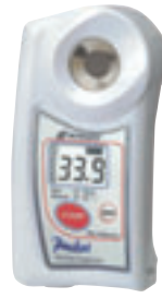
③ ポケット糖度計 PAL-パティシエ H-6 直 寸法・109×55×31 / 電源・DC-3V 測定範囲・0.0~85.0% 糖ポ-メ-度・0~45° 1本 ¥46,200 712-0015 防水仕様で、水で丸洗いが可能 / 自動温度補正 / Brixと糖ポ-メ-度のダブル目盛
