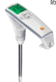
⑰ デジタル食用油テスター 270 K-2 直納3 / 元払・1台 寸法・50×30×354 / 電源・DC-3V 測定範囲・TPM 0.5~40% 温度 40~210℃ 1台 ¥79,200 712-0270 食用油の老化状態を数値で把握できます
