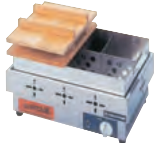
⑫ 電気おでん鍋 N-1 直 / 元払・1台 規格 寸法 仕切数 1台 EOK-6 485×335×180 6仕切 ¥80,000 612-6006 EOK-8 540×360×180 8仕切 ¥96,000 612-6008 EOK-6、100V・1000W / EOK-8、100V・1500W 充分な煮込みと安定した保温ができます 6段切り替えカムスイッチで火力調節できます
