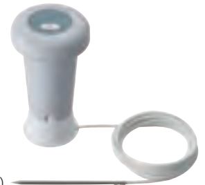
防水型無線温度ロガー(分離タイプ) ⑮ SK-320BT-C H-5 直納3 寸法: 1台 ¥15,000 712-0320 測定範囲・-50~150℃ 測定精度・±1.0℃(-0.1~40.0℃) ±1.5℃(-15~0℃ / 40.1~65℃) ±1.0℃(-30~15.1℃ / 65.1~150℃) ±1.0℃(-50~30.1℃) 使用環境条件・-15~60℃ (一般空気測定の場合やセンサパイプのみ水没の場合は-50~150℃) 【携帯端末の動作条件】 対応OS Ver. iOS 13以上、Android 9以上 無線機能:Bluetooth4.0以上搭載 ■携帯端末にインストールした専用アプリを使用して、記録データの取得をおこないます (Bluetooth機能が付いた携帯端末が必要です) ■本体と携帯端末は複数台で同時接続が可能で複数の測定場所の温度データを表示、取得できます
