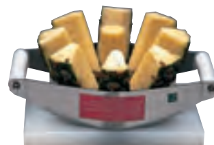
⑥ パインスティックカッター N-6 直 / 元払・2台 規格 パインの大きさ 1台 SC-6 6分割用 ¥45,000 611-0636 SC-8 8分割用 ¥45,000 611-0638 内径190mm 外皮付のまま、芯をぬき、1回でスティックパインがカットできます
